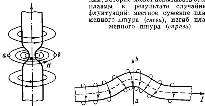
Рис. 3. Простейшие типы деформаций, которые может испытывать столб плазмы в результате случайных флуктуаций: местное сужение плазменного шнура (слева), изгиб плазменного шнура (справа)
